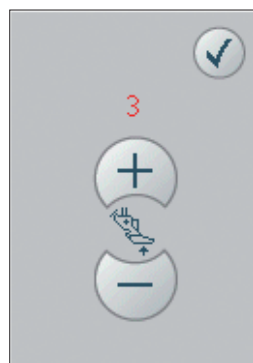
Установка высоты лапки в Сенсорной технике свободного передвижения.
